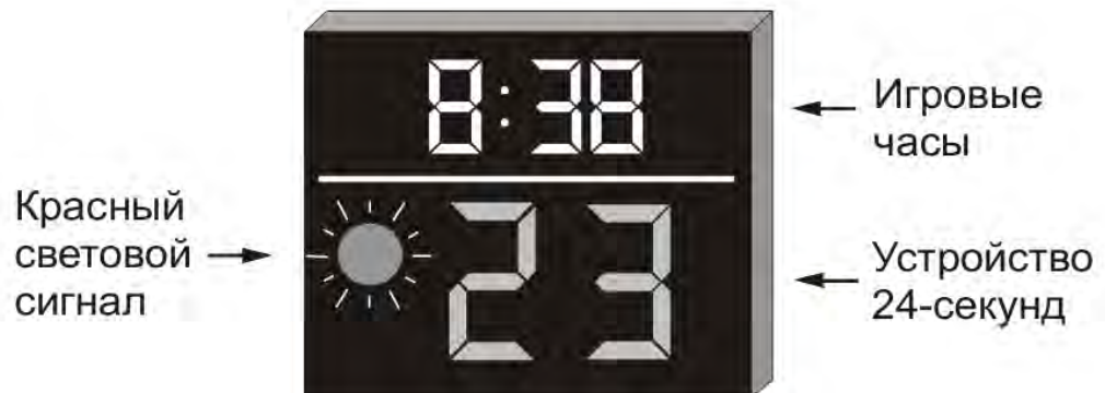
Рис. 9 Дисплей устройства двадцати четырех (24) секунд, дублирующие игровые часы и красный световой сигнал для Уровней 1 и 2 (пример оборудования)
